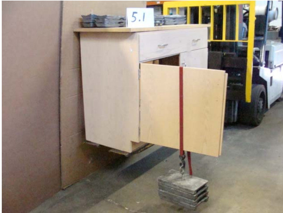
Photo 5: 5.1 Door Hinge Test
